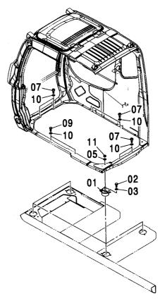
**(M)** サービス 符号 部品番号 数量 適用号機 部 品 名 PART NAME コード ITEM PART NO. Q' TY SERIAL NO. S. C ラハ・ー 01 4409999 Rubber 4 02 4330785 ボルト BOLT 8 03 A590912 ワツシヤ;スフ゜リンク゛ WASHER; SPRING 8 05 J222016 ワツシヤ WASHER 4 07 J781035 ボルト;ソケツト BOLT; SOCKET 4 09 J901030 ボルト BOLT 5 10 J222010 ワツシヤ WASHER 9 11 4423699 ナツト NUT 4
