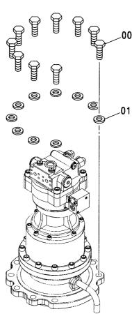
**(M**) T 代替部品 PART 性 部品番号 数量 ICA PART NO. Q'TY 数量サービス 符号 部品番号 適用号機 部 品 名 PART NAME ITEM PART NO. SERIAL NO. Q' TY S. C 00 J922060 **ボルト** BOLT 10 01 J222020 ワツシヤ WASHER 10
