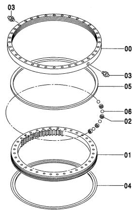
互 代替部品 換 REPLACEABLE PART 性 部品番号 数量 ICA PART NO. Q'TY 符号 サービス 部品番号 数量 適用号機 部 品 名 PART NAME PART NO. ITEM Q' TY SERIAL NO. S. C 9184497 スイング・ナークル SWING; CIRCLE 1 00 ++++++ ・レース:アウター · RACE ; OUTER 1 D 01 ++++++ ・レース;インナ ·RACE; INNER 1 D 02 4127708 ・サポート · SUPPORT 99 03 J75481 ・フイツテンク゛;ク゛リース ·FITTING; GREASE 2 04 4289757 ・シール ·SEAL 1 05 4315493 ・シール ·SEAL 1 06 4428919 ・ボール ·BALL 99
