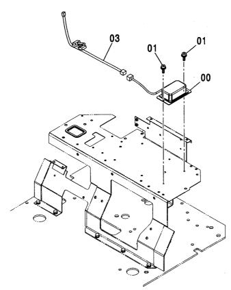
**M** 互 代替部品 PART 性 部品番号 数量 ICA PART NO. Q'TY 符号 部品番号 数量 適用号機 部品名 PART NAME ITEM PART NO. Q' TY SERIAL NO. S. C 00 ュニット;パ゚ワー 4450008 UNIT; POWER 1 01 J460616 スクリユ;セムス SCREW; SEMS 2 03 3091204 ハーネス;ワイヤ HARNESS; WIRE 1
